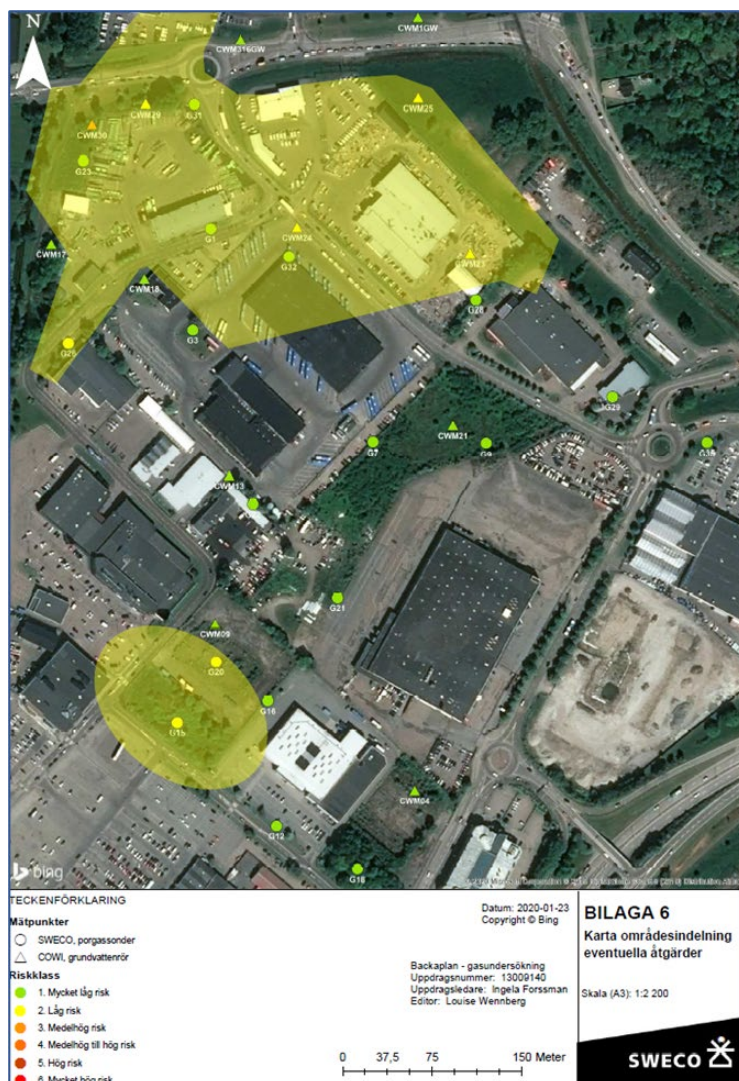
Figur 21. Resultat av mätningar av deponigas, sammanställt av Sweco 2020.
